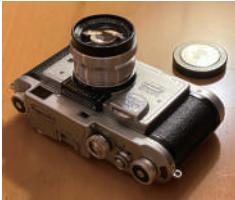
ヘンゾ・リポーターは、ライカ社の本社があるので著名な中部ドイツの都市ヴェツラー (Wetzlar) のヘンゾルト社の銘を掲げているが、じつはミラノ (Milano) のI.S.O. (Industria Scientifica Ottica) 社製だ。『NICHE 05』で登場したビルックスの後継機だが、交換レンズに互換性はない。ビルックス同様、数あるスクリュー・マウント・ライカ派生のカメラの中でも最良のものの一つだろう。高速シャッターと低速シャッターを一つにまとめた一軸回転シャッター（残念ながら不回転ではない）、距離計用ファインダーと構図合わせ用ファインダー（焦点距離5cm用のみ）を一体とした一眼式ファインダーなど、ライカにはない長所もある。合焦はレンズの正面に向かって左上のギアを回して行うというコンタクス方式だ。フィルム巻き上げは正面に向かって左端のノブを回してもできるが、底面にトリガーが格納されていて、これを2回引くことで迅速に巻き上げができる（ビルックスでは1回半だった）。
