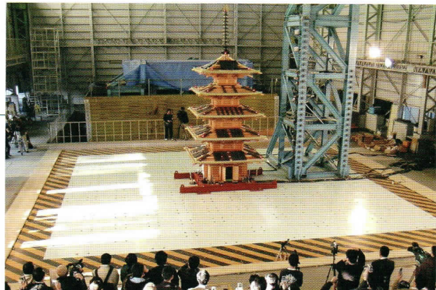
2004年に行った五重塔の模型振動台実験
