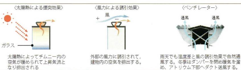
ソーラーチムニー、ベンチレーターの換気原理
