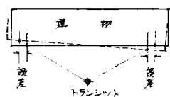
面に直角にトランシットを置く事
