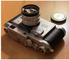
ヘンゾリポーターは、ライカ社の本社があるので有名な中部ドイツの都市ヴェツラー (Wetzlar) のヘンゾルト社の銘を掲げているが、じつはミラノ (Milano) のI.S.O. (Industria Scientifica Ottica) 社製だ。『NICHE 05』で登場したビルックスの後継機だが、交換レンズに互換性はない。ビルックス同様、数あるスクリー・マウント・ライカ派生のカメラの中でも最良のものの一つだろう。高速シャッターと低速シャッターを一つにまとめた一軸回転シャッター (残念ながら不回転ではない)、距離計用ファインダーと構図合わせ用ファインダー (焦点距離5cm用のみ) を一体とした一眼式ファインダーなど、ライカにはない長所もある。合焦はレンズの正面に向かって左上のギアを回して行うというコンタックス方式だ。フィルム巻き上げは正面に向かって左端のノブを回してもできるが、底面にトリガーが格納されていて、これを2回引くことで迅速に巻き上げがなされる (ビルックスでは1回半だった)。
