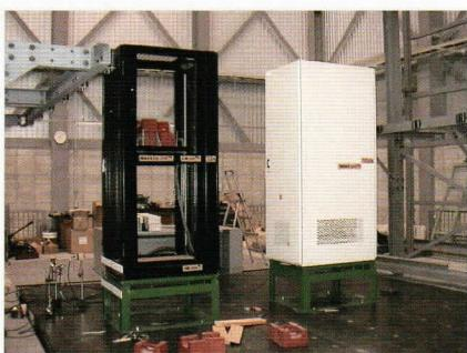
軽量・薄型免震装置の振動実験状況
