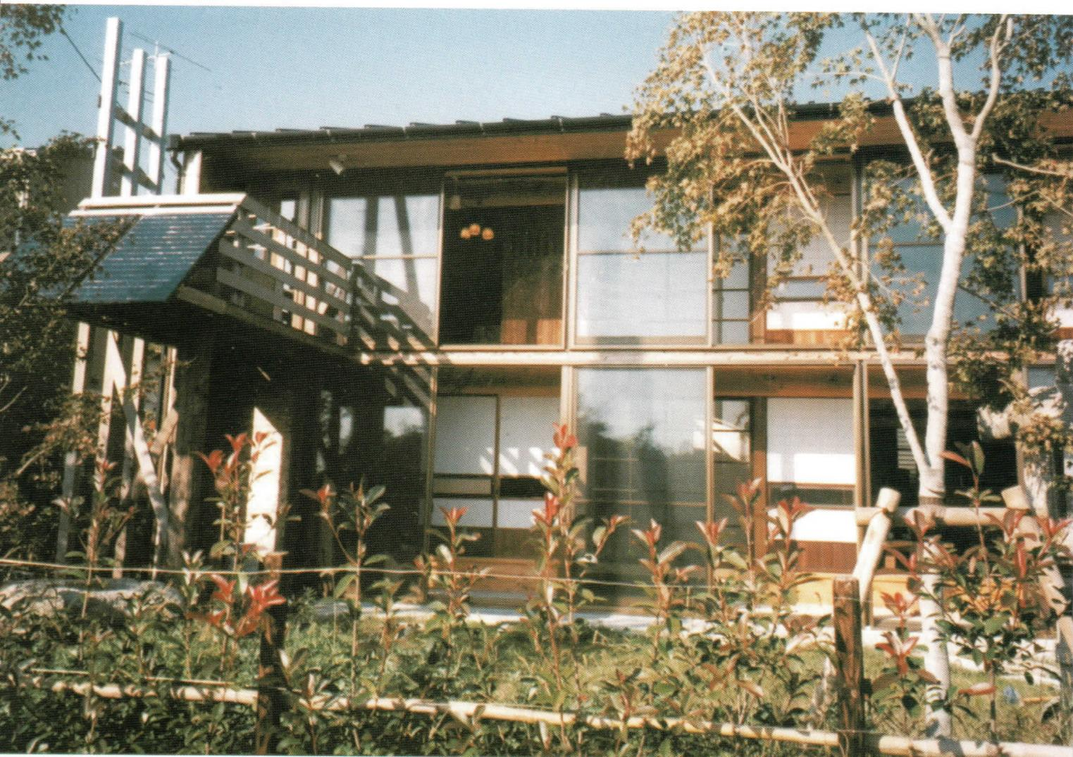
■外観——バルコニーの先端に太陽光発電パネルで、太陽熱による空気を送風するファンの電源としている。
