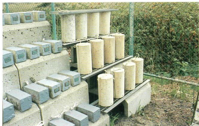
■再生コンクリートの曝露試験(北海道・岩内)
